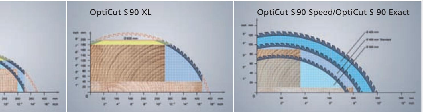
Attention! Lorsque l'on détermine une section de bois possible, il faut tenir compte des flèches et des écarts de dimensions.
