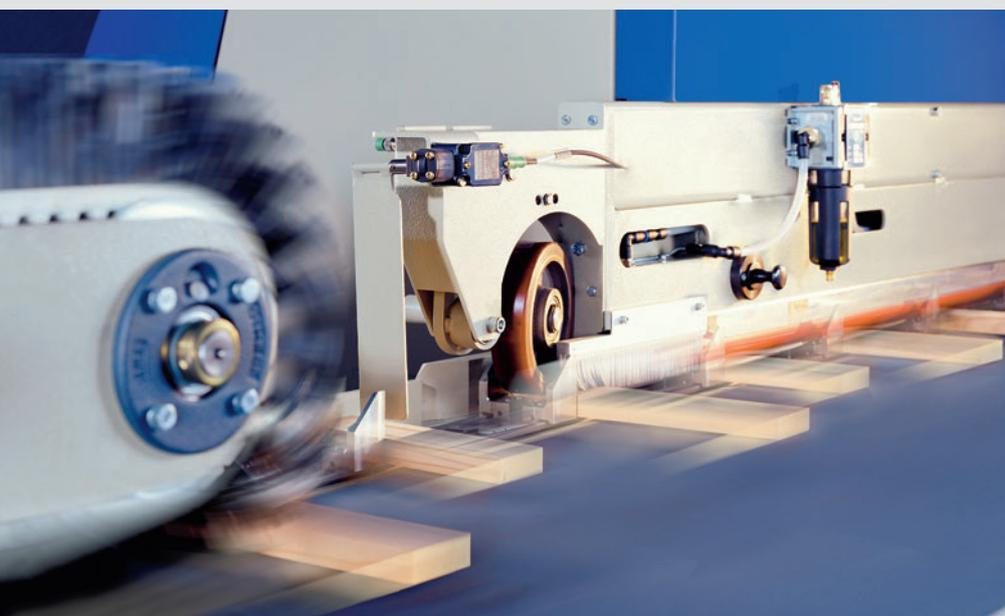
Les fraises d'aboutage simples pour le fraisage horizontal de GRECON sont les plus rapides que l'on trouve sur le marché mondial. Jusqu'à 180 pièces par minute en continu et 12 cycles de pressage par minute font de la machine un géant de la production. Il est même possible d'intégrer des composants supplémentaires de haute puissance comme un chargement automatique. On peut utiliser des outils d'un diamètre de 228,6 à 266,7 mm (9 à 10,5 pouces).
