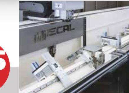
Les axes glissent sur guides de précision et sont entraînés par des moteurs exploités par des systèmes digitales. Tous les systèmes de manutention axes sont lubrifiés par un système centralisé automatique
