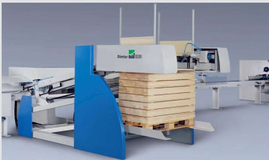
**L'OptiCut Stacker** est la solution idéale quand on produit des longueurs prioritaires. Celles-ci sont empilées de manière entièrement automatique, atteignant une hauteur de pile de 1200 mm et une fréquence jusqu'à 80 pièces / min. Différents types de piles peuvent aussi être sélectionnés dans la commande de la scie.
