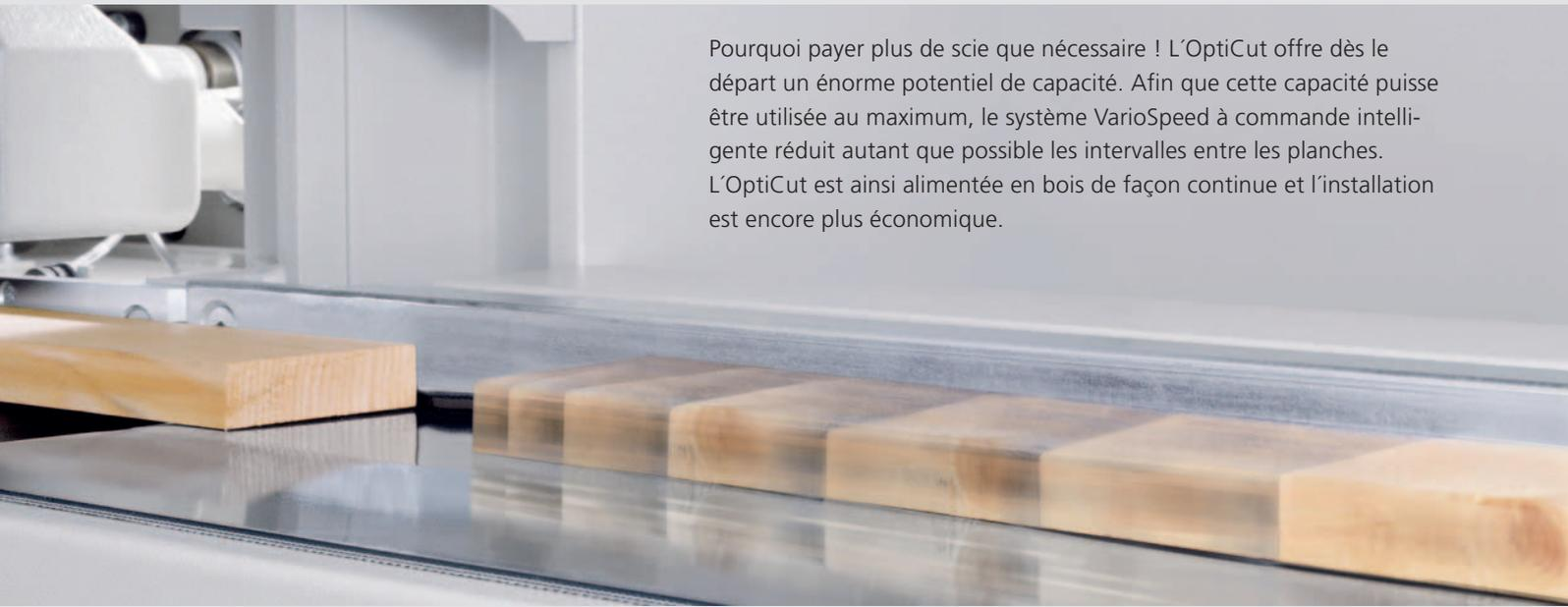
Pourquoi payer plus de scie que nécessaire ! L'OptiCut offre dès le départ un énorme potentiel de capacité. Afin que cette capacité puisse être utilisée au maximum, le système VarioSpeed à commande intelligente réduit autant que possible les intervalles entre les planches. L'OptiCut est ainsi alimentée en bois de façon continue et l'installation est encore plus économique.
