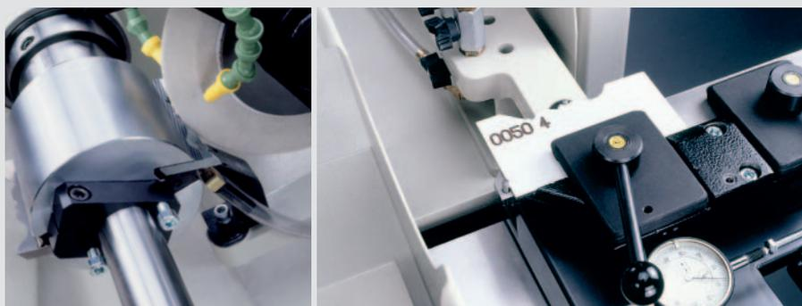
**Les outils à fers** sont profilés et réaffûtés sur le dos, d'après un gabarit profilé, ce qui assure une fidélité du profil absolue et des conditions de coupe optimales pour toute fabrication et tout matériau. Le résultat : des outils tranchants dont la précision de circonférence est parfaite!
