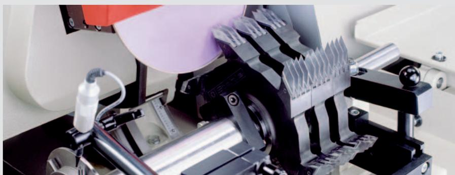
**Les fraises** sont affûtées sur la face. Qu'il s'agisse de fraises individuelles ou de jeux de fraises – la Rondamat se porte garante d'une précision maximale. Les fraises sont utilisées pour des fabrications spéciales telles des bâtons ronds, des rainures ou des profils destinés à l'encollage.
