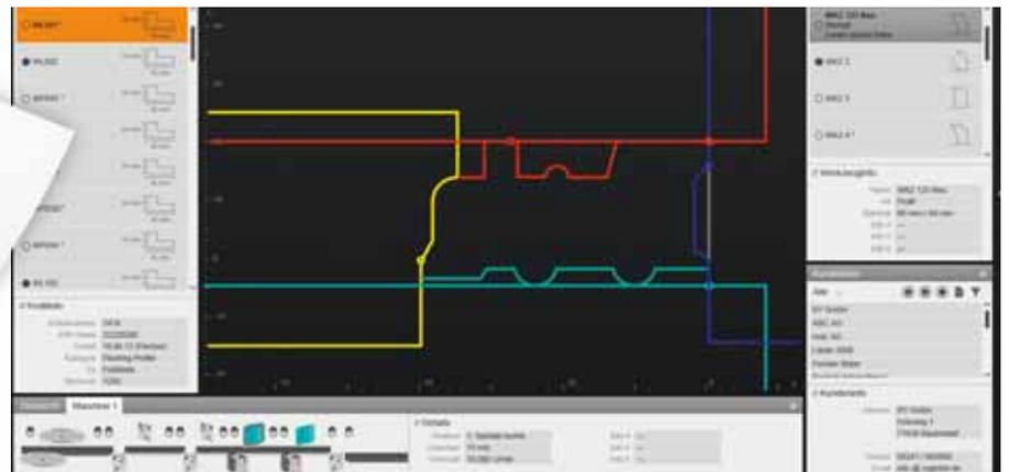
Le **Moulder Master** réalise la liaison entre les différents processus en amont de la production. Combiné à PowerCom Plus, le logiciel couvre l'ensemble du cycle, jusqu'au réglage de la machine. Une interface de CAO permet de créer des dessins des profils et des outils. Vous bénéficiez ainsi d'un cycle de production sans papier aux processus sécurisés, avec une gestion efficace des données enregistrées.
