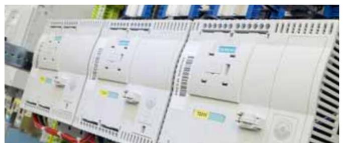
L'équipement électrique de haute technologie de nos moulurières est réalisé en étroite collaboration avec de grandes entreprises internationales, telles que Siemens. Citons, par exemple, les nouveaux démarreurs de moteur qui se paramètrent automatiquement au poids de l'outil justement en service.
