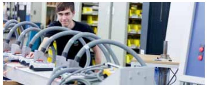
En électricité, un mauvais contact peut avoir des conséquences malheureuses. A la fin de leur montage, les armoires de commande de WEINIG sont soumises à un essai complexe de fonctionnement conforme à des listes de contrôle. Le travail de la moulurière y est entièrement simulé.
