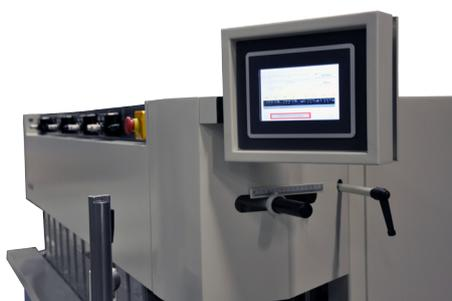
Écran tactile 7" pour les commandes de la machine et démarrage de toutes les moteurs
