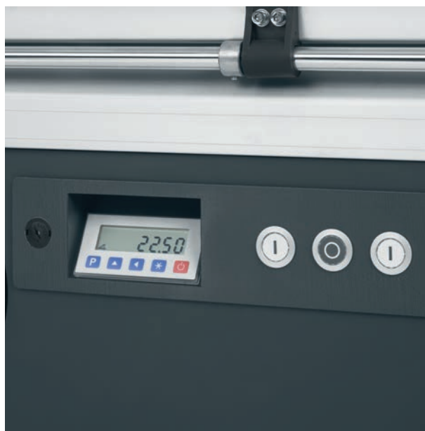
Affichage de la hauteur et l'inclinaison sur un écran LCD.
