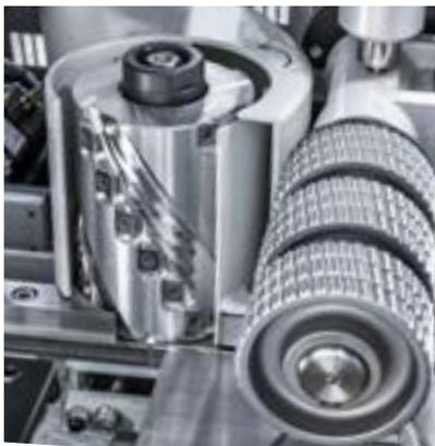
Les porte-outils hélicoïdaux sont équipés de fers au carbure dont la résistance à l'usure est élevée. Ces outils sont exceptionnels pour le préabotage et pour l'usinage de bois durs.
