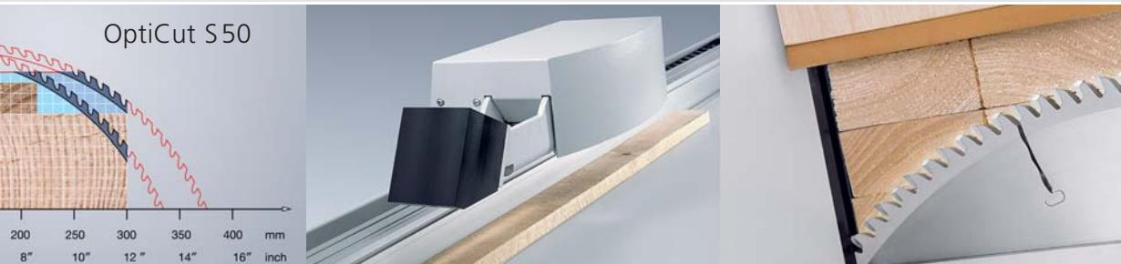
Le transfert, le positionnement, le serrage et le tronçonnage peuvent être effectués automatiquement par l'OptiCut S 50, sans aucun effort même quand il s'agit de pièces lourdes et difficiles à déplacer. Encore un plus : Que vous tronçonnez des pièces différentes à chaque fois ou des séries, vous pouvez adapter l'OptiCut S 50 à vos besoins et à tout moment l'équiper peu à peu d'options, jusqu'à formation d'un centre de tronçonnage complet.
