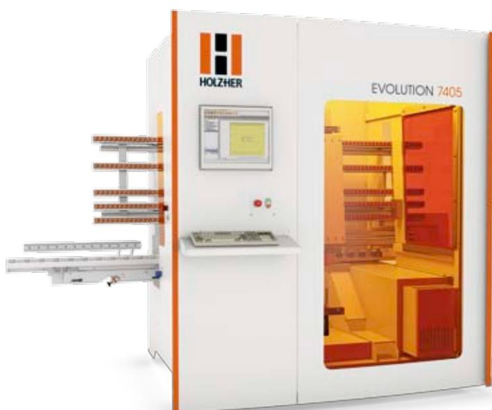
Les données techniques de la série ÉVOLUTION sont suffisamment évocatrices : Usinage de panneaux jusqu'à 920 mm de hauteur et illimité en longueur, pour un encombrement des plus réduits.
