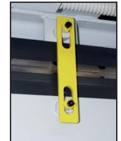
Chiavistello per bloccaggio piani in fase di manutenzione Verrou blocage plateau Dispositivo de bloqueo plato móvil en fase de mantenimiento
