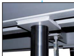
Supporto superiore cilindri libero Appuis libre du cylindre Soporte superior cilindros libres
