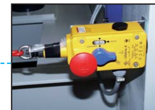
Fune più interruttore di sicurezza Câble et interrupteur de sécurité Cable e interruptor de seguridad
